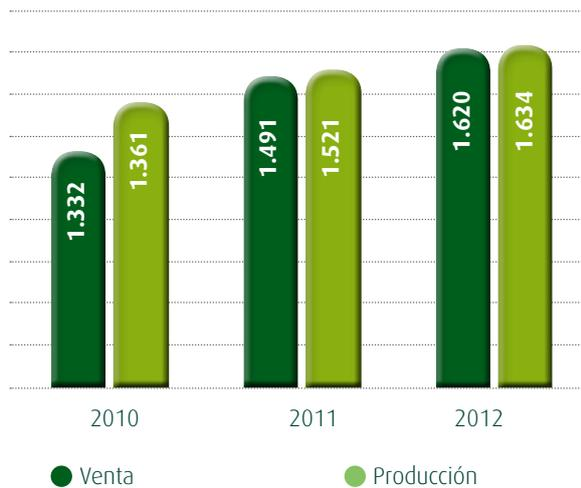
Ence cogenera para **producir electricidad y calor** en sus tres fábricas. La electricidad la utiliza para abastecer las necesidades del régimen de funcionamiento de las propias instalaciones de cogeneración, y el calor se aprovecha en el proceso de producción de la celulosa. El excedente de energía que no se autoconsume, se vende a la red. Tanto la **producción energética** como la venta han aumentado los
