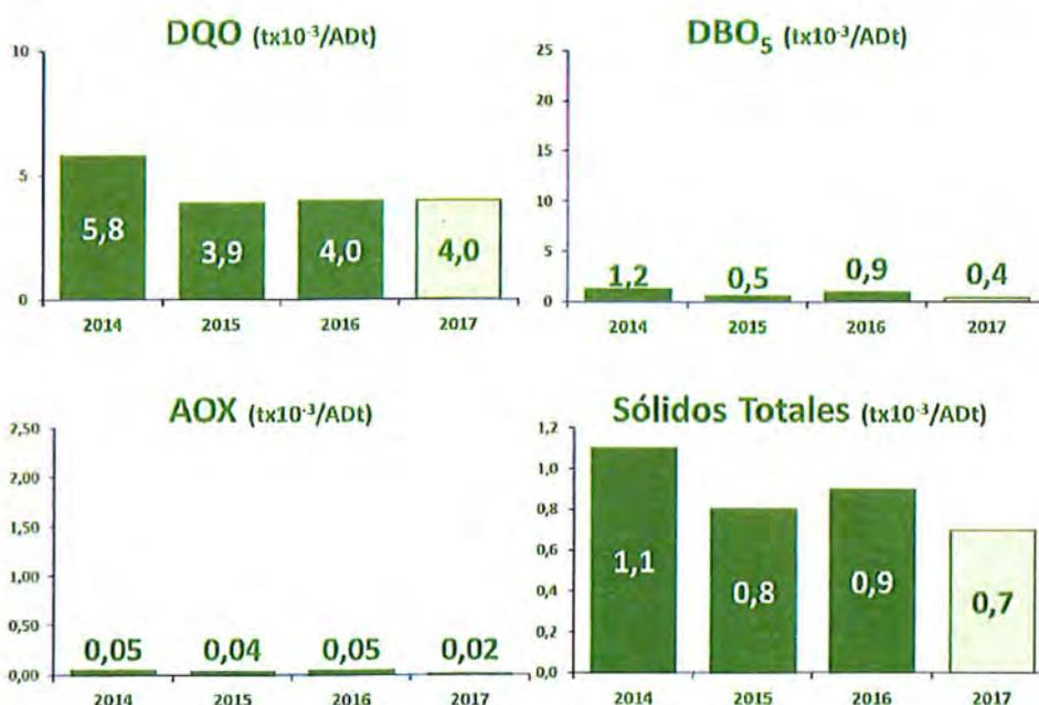
Los resultados de calidad del vertido de Ence Navia en 2017, consolidan la mejora ambiental obtenida con la tecnología BAS™ consiste en implantar un sistema mixto en el cual la carga contaminante influente es tratada por una combinación de biomasa adherida a soporte móvil y biomasa en suspensión. Se trata de combinar un reactor de lecho móvil en cabeza, seguido de un reactor de fangos activos.
