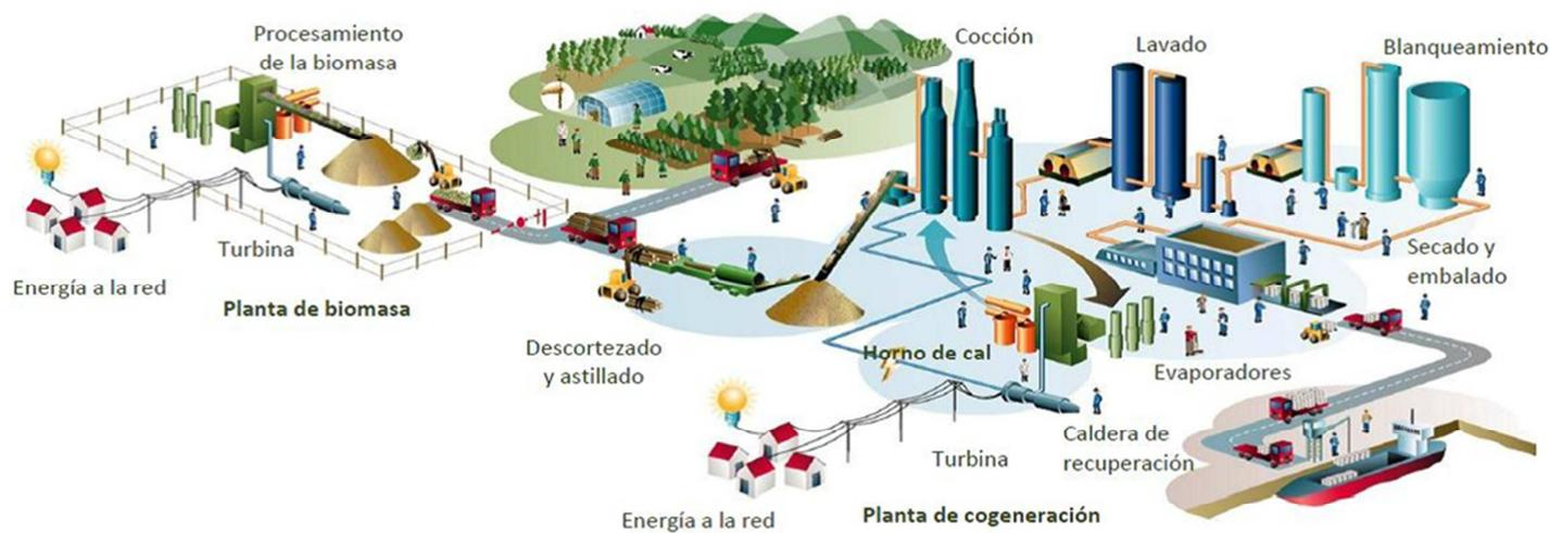
Después de la cocción, la fibra resultante se tamiza, lava y pre blanquea con oxígeno, recuperándose los líquidos residuales que contienen la lignina disuelta en la cocción de la madera. Estos líquidos de cocción son recuperados, evaporados y quemados en una caldera de recuperación que produce vapor de alta presión, mientras que los productos químicos recuperados se regeneran para ser empleados de nuevo en la cocción de las astillas.
